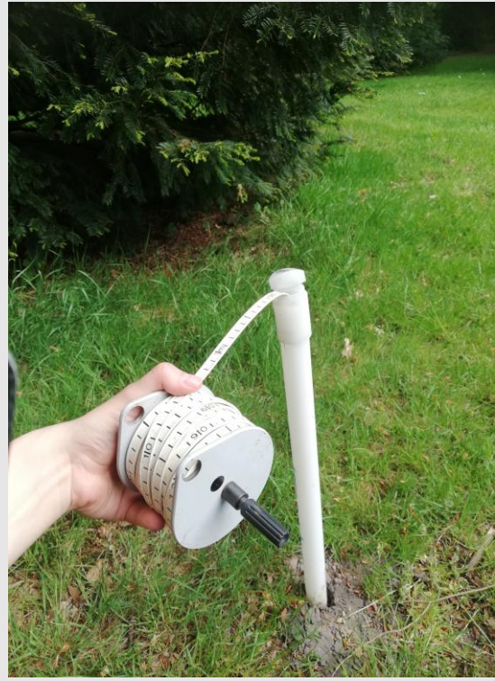
Abb. 1: Messung des Abstichs mit dem Kabellichtlot
